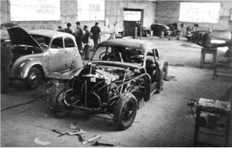
1952 Blick in die Werkstatt von Ghia-Aigle mit einem der beiden Bugatti im Karosseriebau mit einem Hilfsgerüst aus Metallröhrchen.
